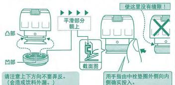
中栓、垫圈的更换 中栓、垫圈为消耗品。建议每年确认一次其状态。
