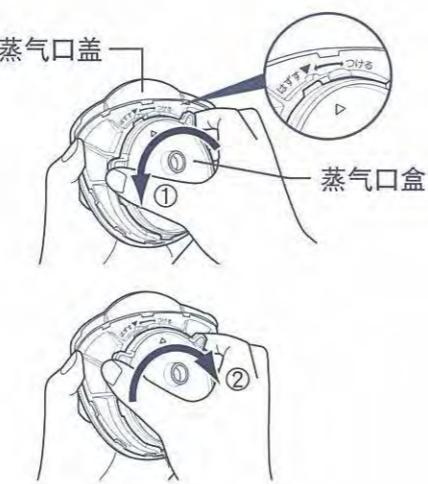
**安装方法** 将蒸气口盖的▽标记对准蒸气口盒的△标记，向“つける（固定）”显示方向转动直至牢固安装(②)
