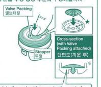
★Foreign matter or dirt stuck to the underside or projecting part of the Valve Packing may cause the beverage to leak ★밸브 패킹 뒷쪽과 장착부에 이물이나 오염이 남아 있으면 음료가 새는 원인이 됩니다.
