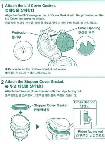
Line up the recess in the Stopper Gasket with the ridge on the Stopper, and, applying pressure from the outside in, push it into place. 뚜껑패킹의 민부와 뚜껑의 凸부를 맞추어 주위에서 밀어 넣듯이 장착합니다.
