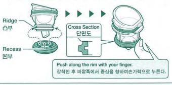
A Attach the Stopper. 뚜껑을 장착한다 Align the opening of the Stopper Cover Opening Set and the tab of the Stopper, and press the Stopper in to attach securely. 민부 본뚜껑세트의 凹부와 뚜껑의 凸부를 맞추고 뚜껑을 아래에서부터 눌러 끝까지 확실히 장착합니다.
