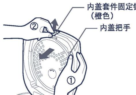
●在没有按压内盖套件固定钩时，请不要强行拉扯内盖把手和内盖垫圈。会造成内盖套件或外盖故障。
