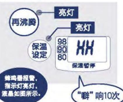
下列情况发生时,为防止过热引起故障,将启动防止干烧功能,加热器断电,通过显示和蜂鸣器报告告知。
