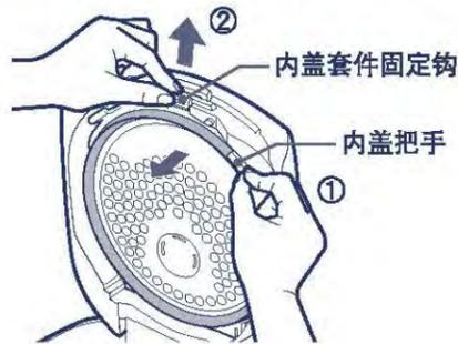
●在没有按压内盖套件固定钩时，请不要强行拉扯内盖把手和内盖垫圈。会造成内盖套件或外盖故障。
