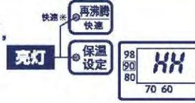
是否水少? 插上插头后，是否马上加入了热水? 防空烧功能已启动。 | 拔下插头，待内容器充分冷却后加水，然后再次插上插头。→ P.9       |
