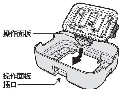
●如图所示,请将操作面板卡入操作面板插口。
